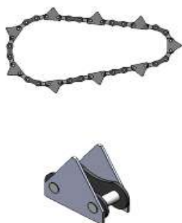
2-rasm Zanjirli uzatma zanjiri va unga mahkamlangan tishlar
