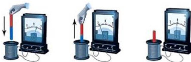
1-rasm. Elektromagnit induksiya hodisasini o'rganishga oid tajriba
