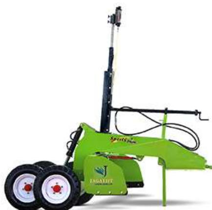
9 – rasm. Hindistonda ishlab chiqarilayotgan Laser Land Leveler yer tekislagichi
