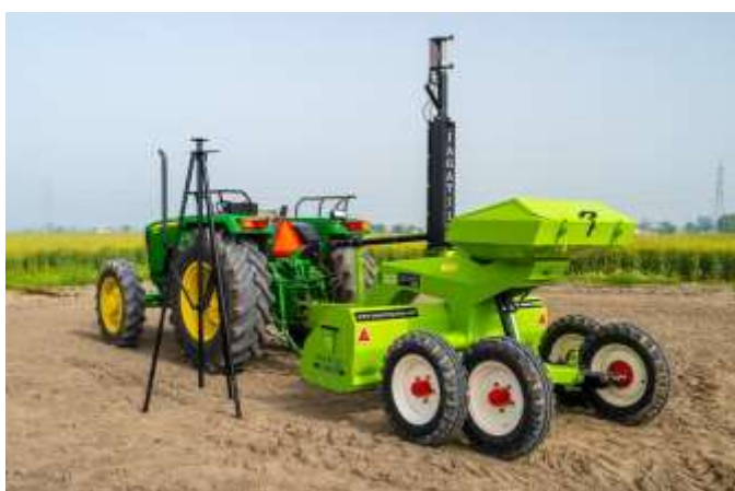
8 – rasm. Jagatjit group lazer leveler firmasi tomonidan ishlab chiqarilgan zamonaviy kombinatsiyalashgan yer tekislagichning dalada ishlash jarayoni
