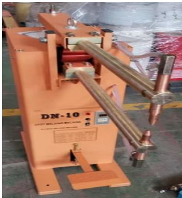
1-rasm DN-10 rusumli kontaktli payvandlash jihozining umumiy ko'rinishi
