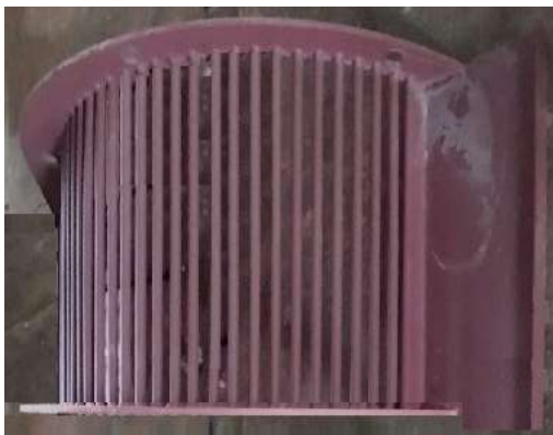
2-rasm. Takomillashtirilgan konstruksiyali kolosnikli panjara
